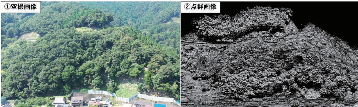
図7 計測地の状況：①空撮画像、②点群画像
