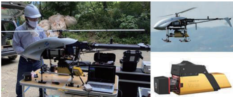
図 1 UAV ヘリコプターとレーザスキャナ
