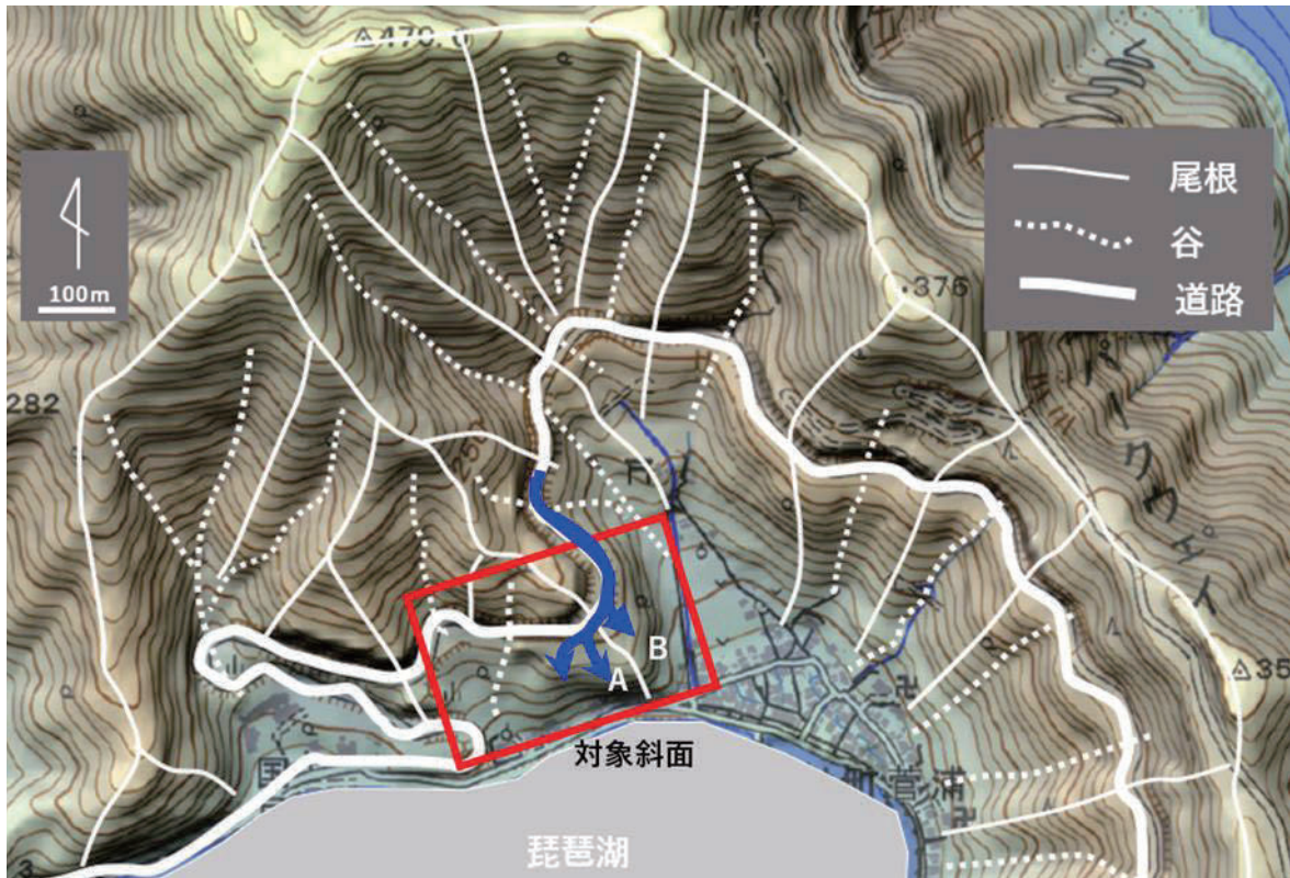
図 12 菅浦背後の地形と対象斜面への道路雨水の流れ（カシミール3Dにより作成）
