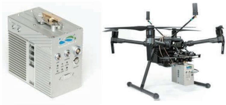
図 2 UAV 搭載型レーザスキャナ（LiAir V）と搭載状況
